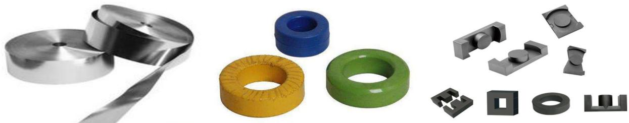
☛测试样品种类：可测试非晶/纳米晶、硅钢、坡莫合金和软磁铁氧体等软磁材料。
